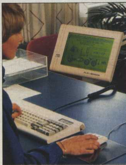
L'écran ASK LCD : un Supertwist pour l'IBM PC.
